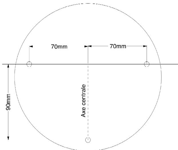
Sur la ligne supérieure, percez un trou de chaque côté à 70mm du centre de la ligne à l'aide d'un forêt à maçonnerie de 6mm et insérez une cheville murale.
